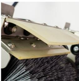
Situé directement sous les brosses, le canal attrape toutes les gouttes de solution et facilite le séchage sous vide. Les protections par pulvérisation en polyuréthane empêchent les éclaboussures vers le haut.
