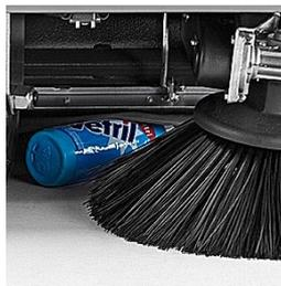
Le dispositif de "lève-flap" s'active à partir du poste de conduite. Il permet à la brosse centrale de ramasser même les déchets les plus imposants et les plus encombrants.
