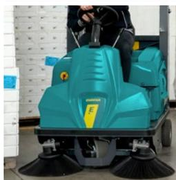
La direction de type voiture, la visibilité offerte et le rayon de braquage de seulement 1050mm, font du Rider-Lift une machine extrêmement polyvalente et agile.
