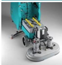
Le châssis standard robuste est en acier, il est protégé par des traitements aux phosphates de zinc, cataphorèses et revêtement par poudre. Dans la version Chrome le châssis, le corps du suceur et les composants mécaniques sont réalisées en acier INOX pour travailler et résister aux environnements hautement corrosifs.
