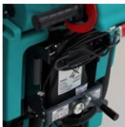
Le chargeur à bord permet de recharger la batterie facilement et de façon idéale. Selon le type de batterie installée, la machine peut être rechargée aussi dans un environnement peu ventilé.
