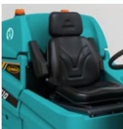
Les capteurs de présence du conducteur, la ceinture de sécurité et la possibilité de couper le contact en cas d'urgence ou d'entretien garantissent une protection et une sécurité maximales aux opérateurs et mécaniciens.
