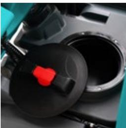
Le réservoir de la solution a une capacité de 120L. Deux hublots en facilitent le remplissage d'eau, l'inspection et le nettoyage.
