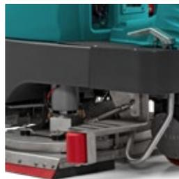
Châssis et détails en acier INOX. La version Chrome® garantit une résistance à l'oxydation et à la rouille, la E85 est adaptée aux contextes corrosifs et aux détergents agressifs.
