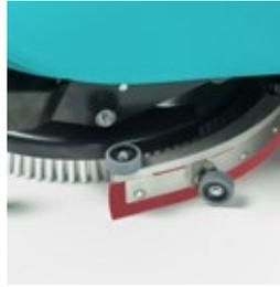
Le système innovant de récupération d'eau au sol garantit un enlèvement maximal de la saleté et un séchage parfait, pour un sol propre et praticable immédiatement.
