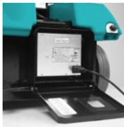
Deux batteries de 12V garantissent à la E46 une autonomie de travail de 2h10 à chaque cycle de charge. Le charge batterie à bord est protégé par une structure en acier facile d'accès.
