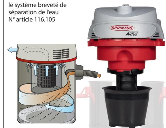
Grâce au tourbillon créé par le tube d'admission, la brume de pulvérisation est séparée la paroi du récipient. Des matériaux filtrants ne sont plus nécessaires. Interruption automatique par flotteur, également lors de la formation de mousse. Des fentes d'aération latérales veillent à une séparation conséquente d'air de refroidissement et d'air de processus.
