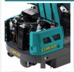
Tous les organes mécaniques internes sont facilement accessibles pour les opérations d'entretien puisque les panneaux postérieurs peuvent s'ouvrir complètement. Les batteries (version EB EVOLUTION) peuvent être remplacées facilement et rapidement.
