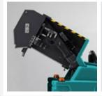
Le conteneur à déchets, à décharge multiniveaux est doté d'un hayon d'ouverture/fermeture à contrôle hydraulique. Il est situé sur la partie postérieure, a une capacité de 150 litres il et peut être soulevé hydrauliquement du sol jusqu'à une hauteur de 1350mm.
