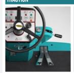
La XTREMA possède un puissant système de traction, à vitesse variable, jusqu'à 9km/h, contrôlé à l'aide d'une double pédale (marche avant et marche arrière).
