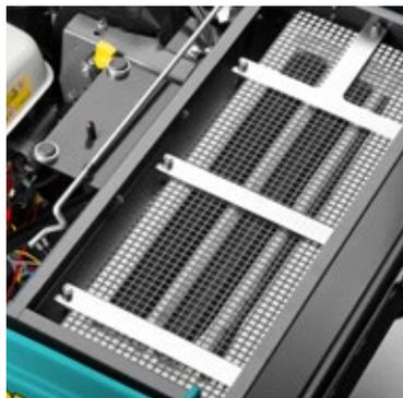
Il se compose d'une structure spéciale multipoche à grande surface de filtration. Avec un degré de filtration jusqu'à 99,9%, elle garantit un air déchargé dans l'environnement d'une excellente qualité et ce de façon durable. En plus des caractéristiques citées, elle est lavable, résistante à l'eau et à l'huile, autonettoyante et facile d'entretien.
