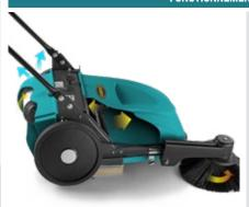
La roue latérale de la balayeuse, en plus d'activer la brosse centrale pour la récolte des déchets, fait tourner rapidement un arbre de transmission relié à un ventilateur qui, grâce au rapport des diamètres (roue- arbre de transmission), aspire toute la poussière et la guide vers le filtre. Le système permet d'intégrer à une balayeuse manuelle un système efficace d'aspiration/filtration qui ne nécessite pas de motorisation, afin de garantir simplicité, économie et écologie.
