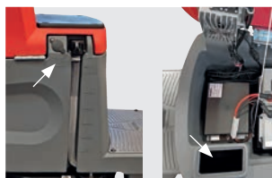
Ouverture de remplissage (tuyau ou seau) et graduation pour le réservoir d'eau fraîche
