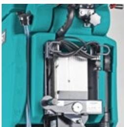
Le chargeur à bord permet de recharger la batterie facilement et de façon idéale. Selon le type de batterie installée, la machine peut être rechargée aussi dans un environnement peu ventilé.
